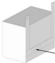
ESTRUCTURA DE PLETINA PARA SUJECCIÓN DE BASES PORTAFUSIBLES
